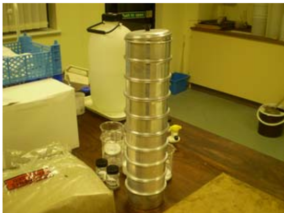
写真 生徒の Plan に合うように粒子の大きさを調整する装置
