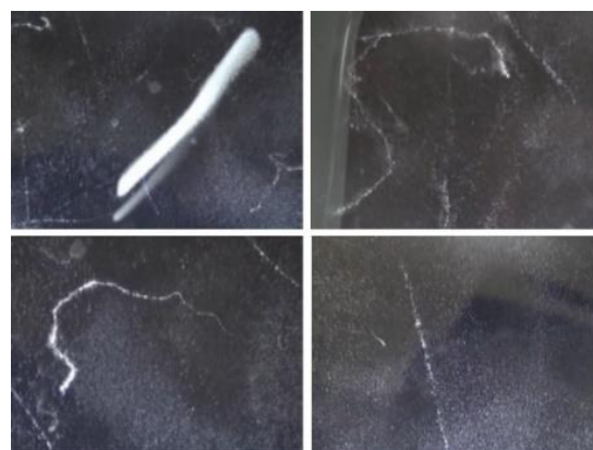
図2 霧箱で観察した放射線の飛跡 (左上： \alpha 線，右上： \beta 線，左下：コンプトン電子，右下：宇宙線)
