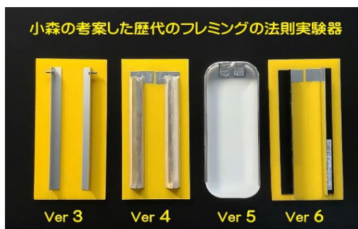
図2 フレミングの法則実験器
