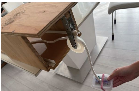
図3 台車定加速装置 +おもり
